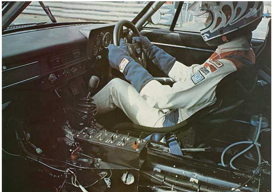
Tous les interrupteurs sont regroupés sur une console centrale.
