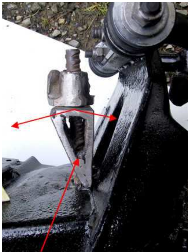
Pièce en V permettant l'articulation de la tige filetée
