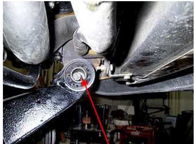
Mettre en place les 2 boulons sans les entretoises pour avoir du jeu lors de la mise en place définitive, bien graisser les axes
