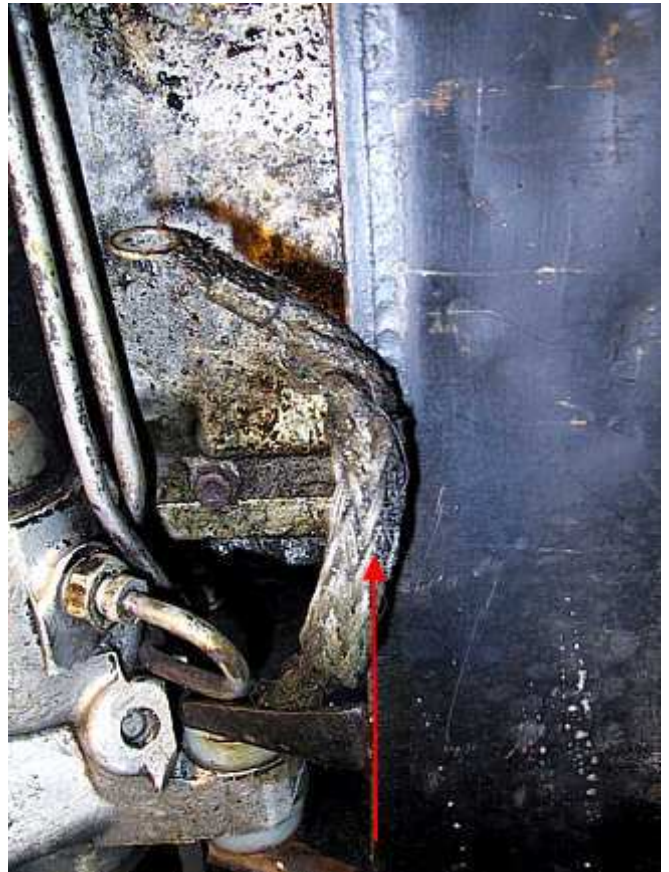
Tresse de masse du moteur au berceau à débrancher
