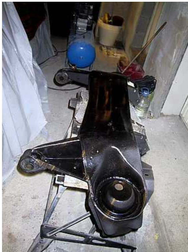
Le berceau prêt à remonter, passage d'une couche d'anti-rouille, une couche d'anti-gravillon et une couche de peinture, ne pas oublier d'injecter de l'anti-rouille à l'intérieur.
