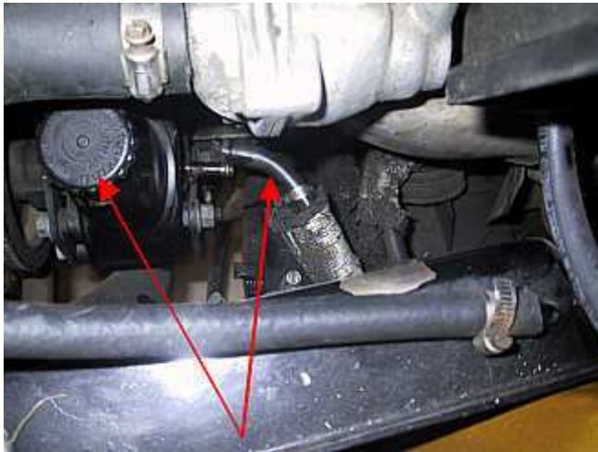
Après avoir vidé le réservoir de direction, débrancher la durite de retour
