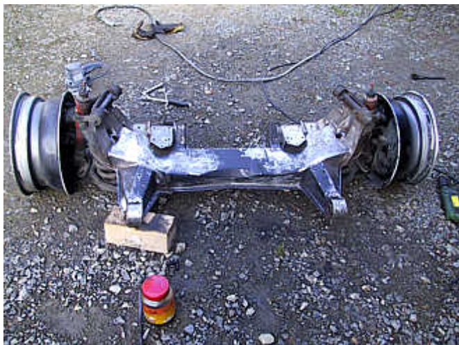
Mise à nu de la tôle
