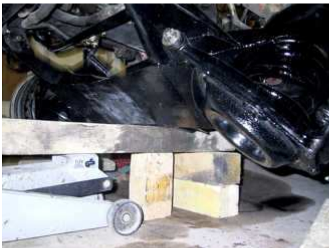
Faire remonter le train AV à l'aide d'un cric.
