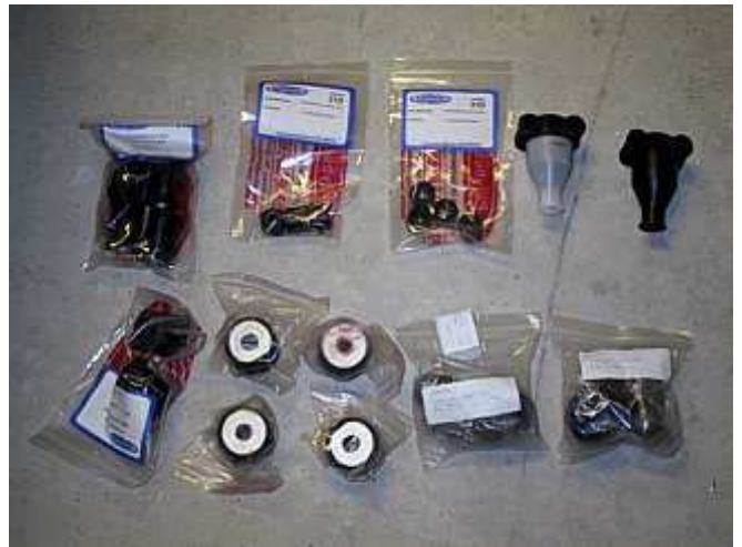
Les nouvelles pièces : silentblocs, rotules inférieures et supérieures
