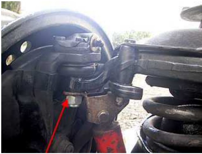
Ecrou de rotule à serrer avant de démonter le compresseur de ressort
