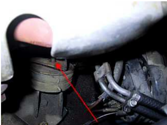
Enlever les écrous des supports moteur gauche et droit
