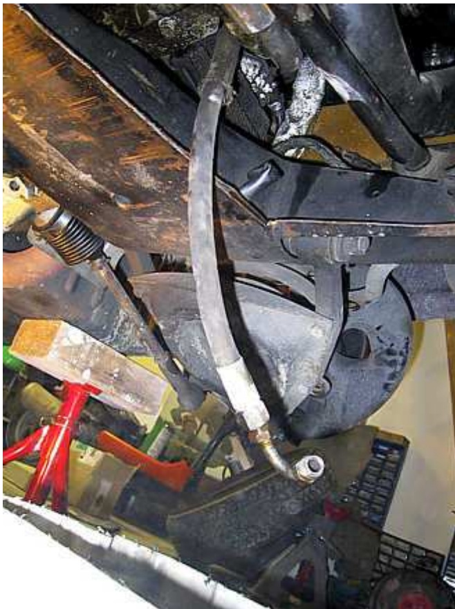
Débrancher la durite de DA entre la pompe et la crémaillère, sans oublier de mettre un bac en dessous, ça coule !!!!
