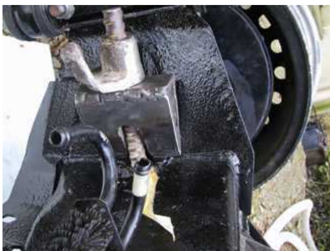
Pièce en V permettant l'articulation de la tige filetée
