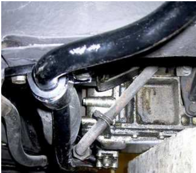
Commencer par monter la barre anti-roulis
