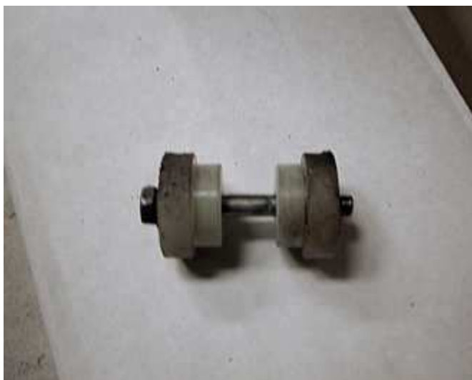
Lors de la réfection de la crémaillère, j'ai changé les silentblocs d'origine pour des bagues en téflon, faites maison, ce qui améliore la tenue de route
