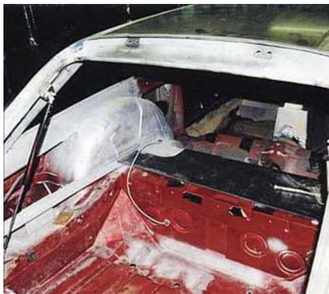
Les passages de roues sont spécifiques, tout comme les caissons latéraux qui les prolongent. On voit ici le positionnement des vérins de maintien du hayon
