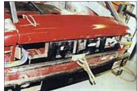
La réalisation du hayon est complexe puisqu'elle utilise la partie arrière du panneau de coffre d'origine (dont la courbure doit être ajustée à l'inclinaison particulière du hayon), et d'autres parties spécifiquement construites
