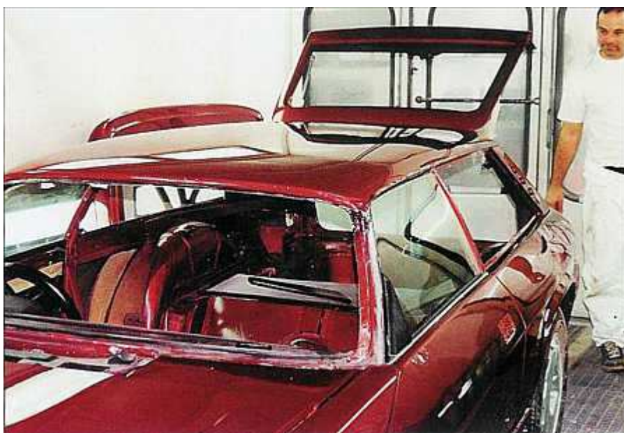
Après l'assemblage des nouveaux éléments de la carrosserie, un gros travail de préparation est nécessaire avant le passage en peinture
