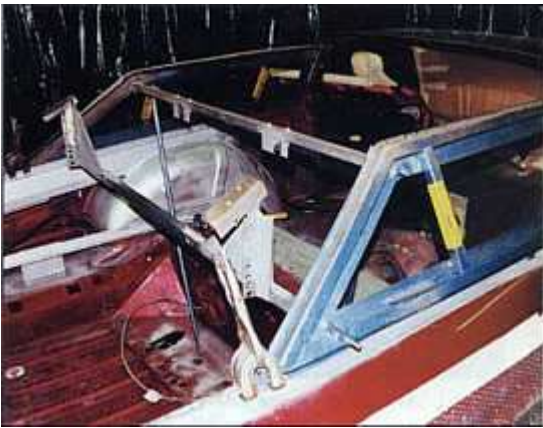
Une fois découpée la partie supérieure du coupé, des renforts sont provisoirement mis en place pour éviter toute déformation de la coque
