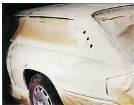
Après l'assemblage des nouveaux éléments de la carrosserie, un gros travail de préparation est nécessaire avant le passage en peinture
