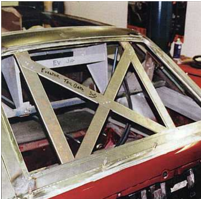
Le hayon est constitué d'éléments préalablement fabriqués et soudés entre eux. Il faut pas loin d'une vingtaine d'essais de présentation du hayon, pour arriver à un ajustage parfait
