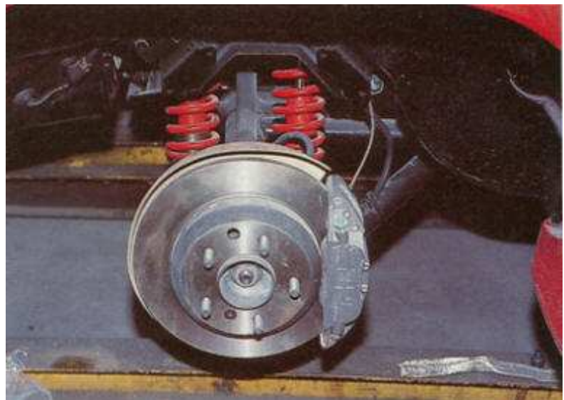
Système de freinage et géométrie de suspension. Le train arrière de la XJ-S Le Mans est complètement remanié.
