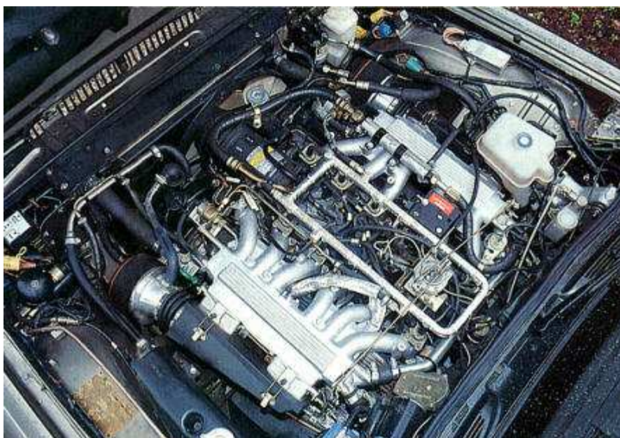
Filtres à air modifiés, tout comme les collecteurs à deux papillons d'admission d'air au lieu d'un. Ici, sous le capot d'une berline XJ 12.
