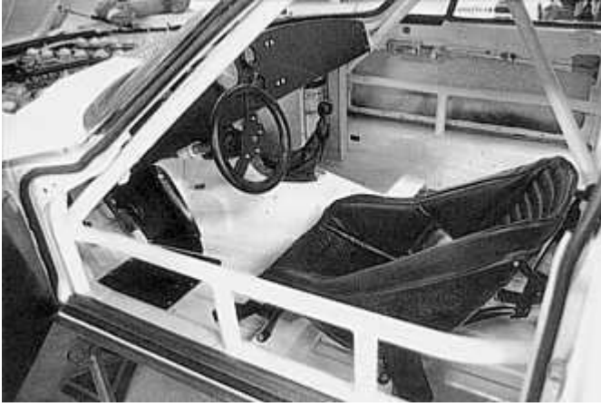
Les renforts de la coque du coupé. L'intérieur est super-allégé...
