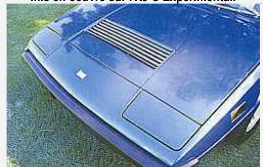
Pour la Ferrari 308 GT4, l'extraction de l'air chaud par le dessus du moteur a été utilisée avant que les XJ-S ne soient commercialisés, en 1975.
