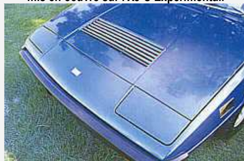
Pour la Ferrari 308 GT4, l'extraction de l'air chaud par le dessus du moteur a été utilisée avant que les XJ-S ne soient commercialisés, en 1975.
